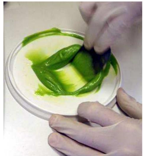
L'utilisation d'un mélangeur statique permet un mélange efficace, facilement contrôlable par l'homogénéité de la couleur verte en sortie de canule.
